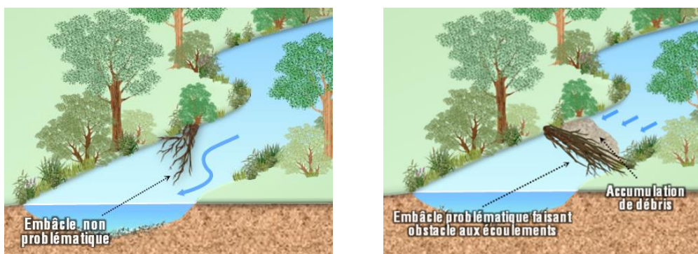
Figure 28. Schéma de principe des travaux de retrait d'embâcles
